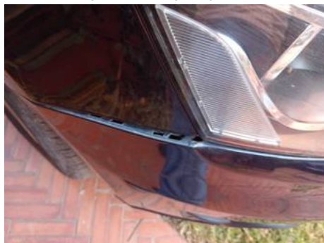
Bouclier avant (Défaut aspect)
