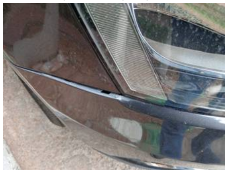
Bouclier avant (Défaut aspect)
