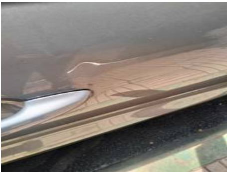
Porte avant droite (Impact)
