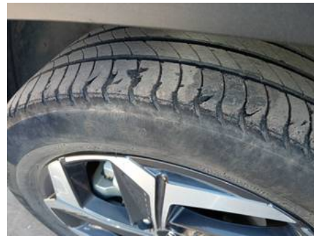
Pneu avant gauche (Usure 25%)
