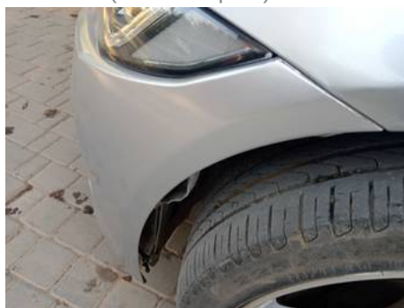
Bouclier avant (Défaut aspect)
