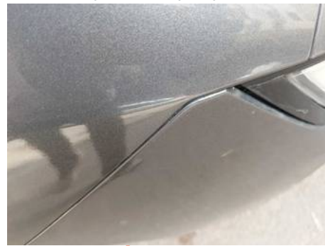
Aile avant droite (Défaut aspect)
