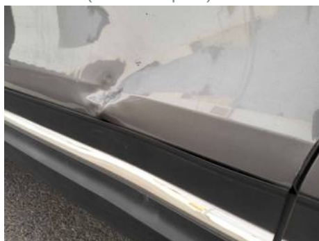
Porte avant gauche (Défaut aspect)
