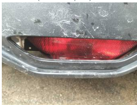
Bouclier arrière (Défaut aspect)
