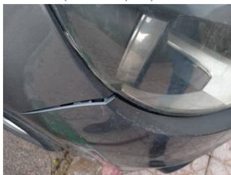
Bouclier avant (Défaut aspect)
