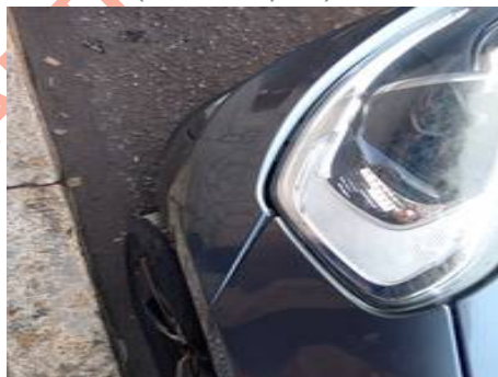
Bouclier avant (Défaut aspect)
